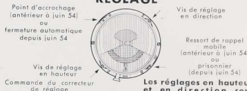
Les réglages en hauteur et en direction sont rigoureusement indépendants.
