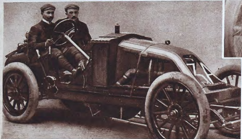
El motor monocilíndrico de Sizaire, que fué uno de los que evidenciaron rápidos progresos de potencia específica. Su primera realización desarrollaba nueve caballos por litro, potencia específica que llegó a ser de 22 caballos por litro en sus últimos modelos.
